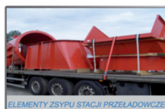
ELEMENTY ZSYPU STACJI PRZELADOWCZEJ
